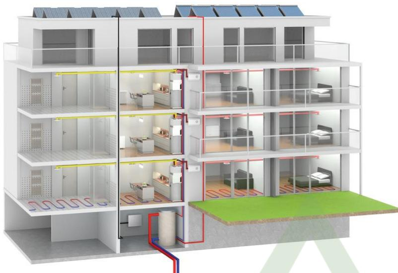
Модульный тепловой насос вода/вода MWL компании **Remko** может вентилировать и отапливать помещения, охлаждать и нагревать питьевую воду. Система использует энергию, поступающую от буферного источника, установленного в центре здания.
